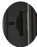
Nota: La tarjeta TF solo se utiliza para almacenar y reproducir la grabadora de conducción. El software de reproducción de música no puede leer esta ranura para tarjeta.
