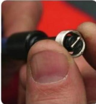
Setzen Sie den Spiraleinsatz in den Applikator ein.
