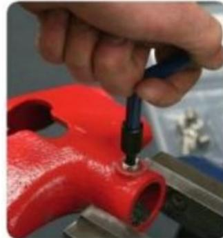
Schrauben Sie die Spirale in das Gussteil ein.
