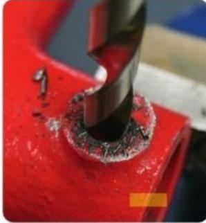
Bohren Sie das beschädigte Gewinde mit einem Bohrer der richtigen Größe aus (im Lieferumfang enthalten).
