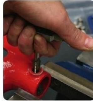
Bearbeiten Sie das nachgebohrte Loch mit dem mitgelieferten Gewindebohrer.
