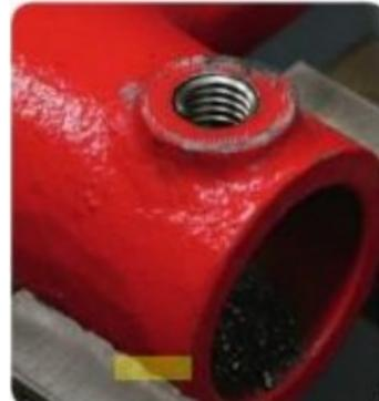
Das Gewinde ist instandgesetzt und einsatzbereit.
