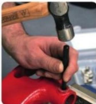
Brechen Sie die Nase am Spiraleinsatz mit dem Brechwerkzeug ab.
