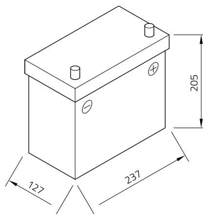
Technologie Geschlossene EFB (Enhanced Flooded Battery = weiterentwickelte Nass-Batterie) | gefüllt und geladen | wartungsfrei
